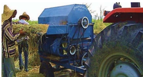
شکل ۴-۴- خرمنکوب تراکتوری جریان محوری
