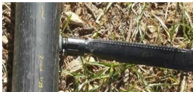
شکل ۶- استفاده از لوله پلی‌اتیلن (سمت راست) یا لیف لت (سمت چپ) به عنوان مانیفولد
