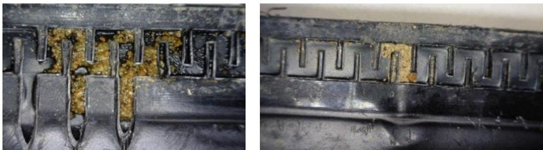
شکل ۸- انسداد مسیر حرکت آب در لوله‌های نوار قطره‌ای تیپ
