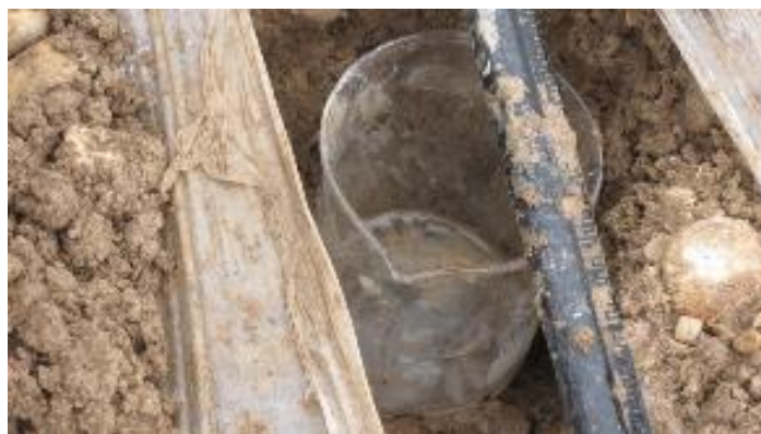
شکل ۱۲- نحوه اندازه‌گیری آبدهی روزنه‌های تیپ در مزرعه
