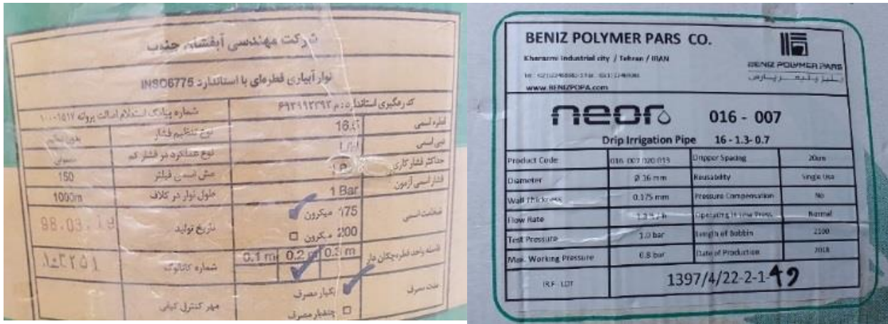
شکل ۹- نمونه ای از برچسب مشخصات لوله تیپ پلاک دار و کنار دوخت
