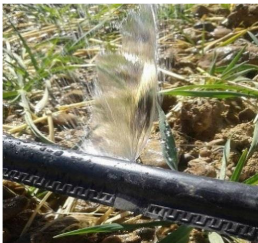
شکل ۲۰- سوراخ شدگی یا بریدگی نوارهای تیپ و تجمع آب در قسمتی از مزرعه
