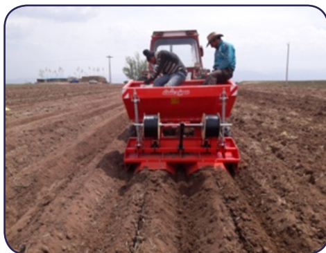
شکل ۲۶- دستگاه غده کار چهار ردیفه زیگزاکی با دو نوار تیپ روی دو پشته به عرض ۱۵۰ سانتی متر
