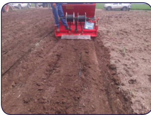
شکل ۲۷- دستگاه غده کار چهار ردیفه با دو نوار تیپ روی دو پشته به عرض ۱۸۰ سانتی متر
