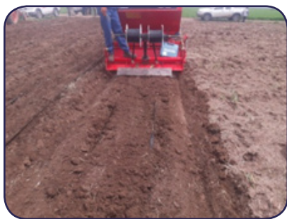
شکل ۲۵- دستگاه غده کار سه ردیفه با دو نوار تیپ روی یک پشته به عرض ۱۵۰ سانتی متر
