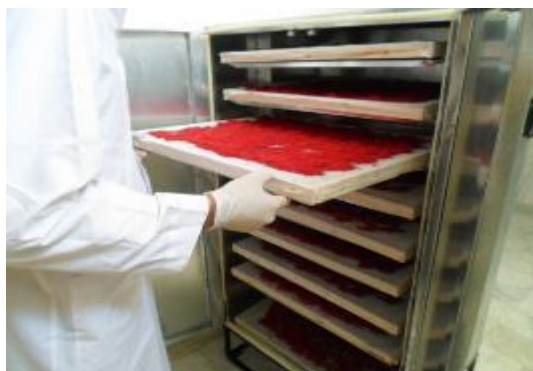
شکل ۵-۵- خشک کن کابینی در حالت بارگیری سینی‌های محتوی کلاله‌های زعفران (سعیدی راد و همکاران، ۱۳۹۳)
