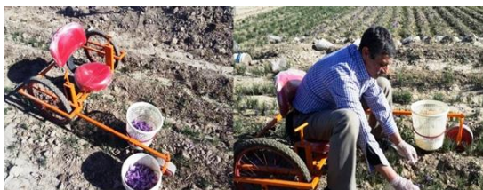
شکل ۲-۶- صندلی چرخ دار کمک برداشت (عباسپور فرد و همکاران، ۱۳۹۷)
