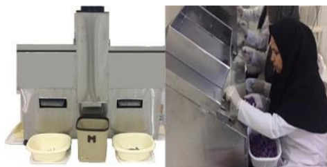
شکل ۴-۱۰- مجموعه دستگاه فرآوری زعفران (برش، جداسازی کلاله از گل و خشک کردن) (سعیدی‌راد، ۲۰۲۰)
