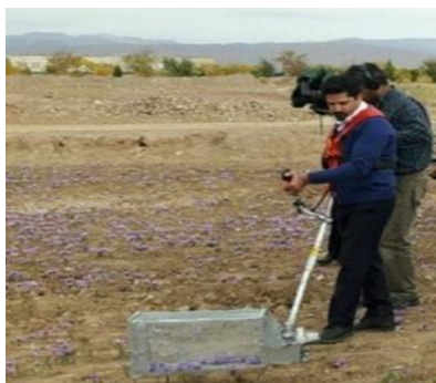
شکل ۲-۹- دستگاه پرتابل برداشت گل بدون مکنده جمع آوری گل
