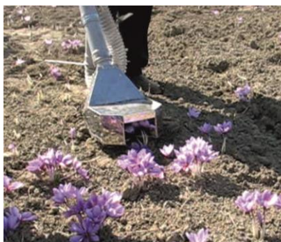
شکل ۲-۷- دستگاه قابل حمل برداشت گل زعفران (سعیدی راد و همکاران، ۱۳۹۳)
