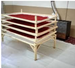
شکل ۵-۳- خشک کردن زعفران با انتقال هوا
