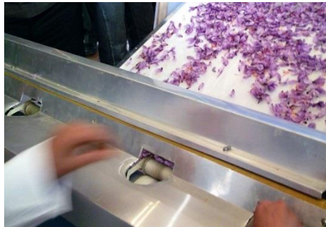
شکل ۴-۹- واحد برش گل از مجموعه دستگاه فرآوری زعفران، طراحی و ساخته شده
