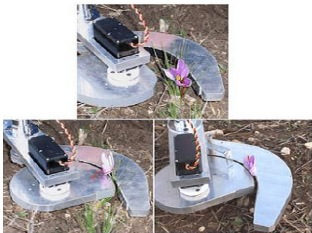
شکل ۲-۸- واحد برش در دستگاه های مکانیزه برداشت (Bertetto and Ricciu, 2012)
