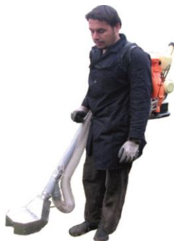
شکل ۲-۷- دستگاه قابل حمل برداشت گل زعفران (سعیدی راد و همکاران، ۱۳۹۳)
