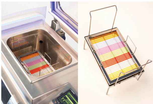
شکل ۷- راست: رک (Rack) و پایوت‌های چیده شده بر روی آن، چپ: نمایی از رک و پایوت‌ها در فریزر اتوماتیک
