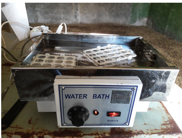
شکل ۲۳- بالا: حمام آب گرم (بن‌ماری)، پایین: بن‌ماری حاوی آب و رک میکروتیوپ در آن
