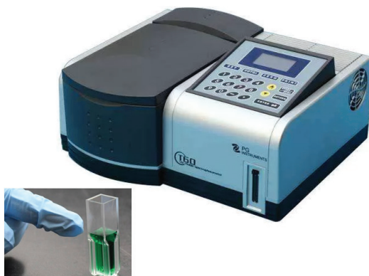
شکل ۴۰- دستگاه اسپکتروفتومتر UV/Vis و سل (Cuvette) دستگاه که محل قرارگیری نمونه محلول است.
