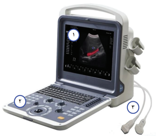
شکل ۱- اجزای اصلی دستگاه سونوگرافی، ۱: صفحه نمایش، ۲: صفحه کلید، ۳: پراب
