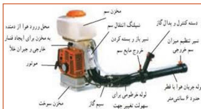
شکل ۳۷- سم پاش اتومایزر پشتی
