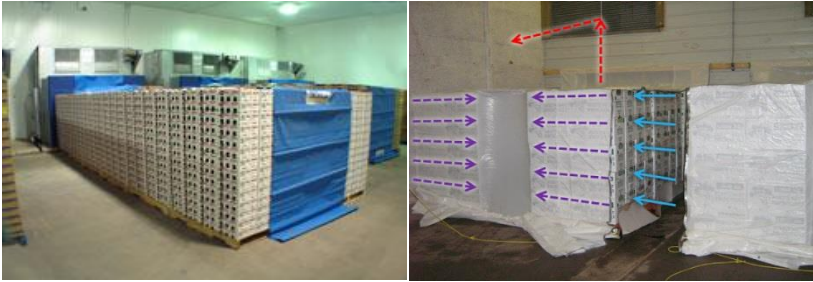
شکل ۱-۱۸- پیش سرد کردن محصول با جریان هوای فشرده (شرکت TRJ، ۲۰۱۹)
