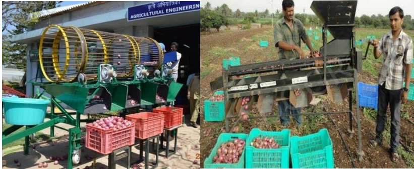
شکل ۱۱- درجه بندی کننده میله ای (راست) و استوانه ای (چپ) پیاز
