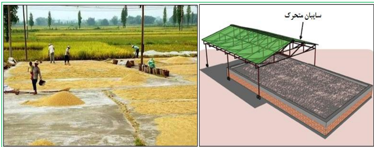
شکل ۵- خشک کردن شلتوک در فضای عمومی و بکارگیری سایبان‌های متحرک در زمان بارندگی (اینترنت)
