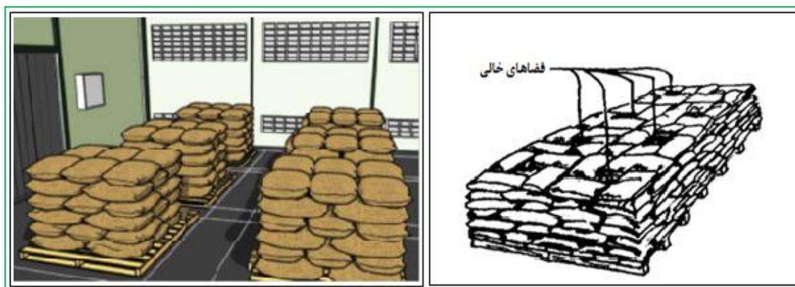
شکل ۱۵- قرار دادن کیسه‌ها روی پالت چوبی و در نظر گرفتن فضای خالی در بین کیسه‌ها (سمت راست: استاندارد ملی فیلیپین، ۲۰۱۵)
