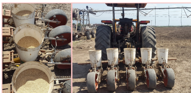
شکل ۷: ردیف کار پنبه با موزع مخصوص برای کاشت کنجد
