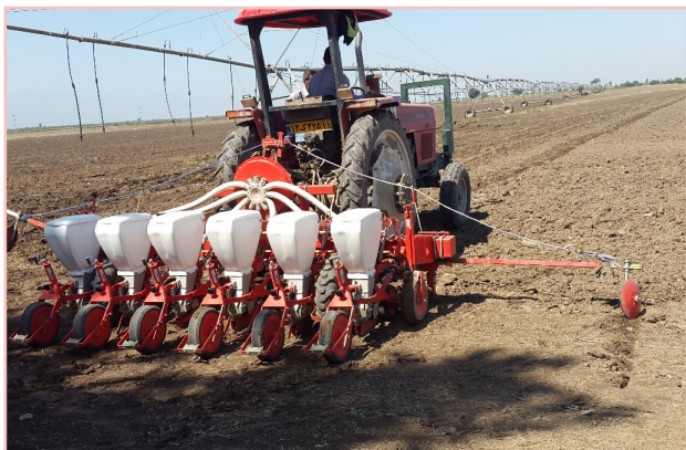
شکل ۵: ردیف کار پنوماتیک با قابلیت تنظیم فاصله بوته بین و روی ردیف کاشت با صفحه موزع مخصوص
