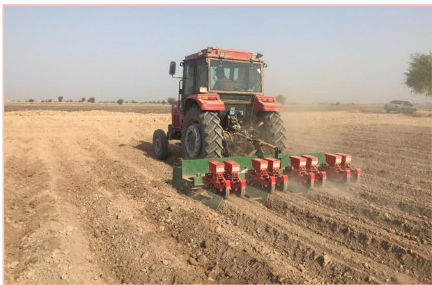
شکل ۶: ریزدانه کار کنجد برای کاشت در بستر بلند
