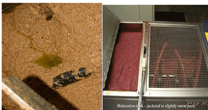
شکل 3- ورز دادن (مالاکسیون) خمیر زیتون (شکل سمت راست) و به دنبال آن خمیر با روغن آزاد (شکل سمت چپ).
