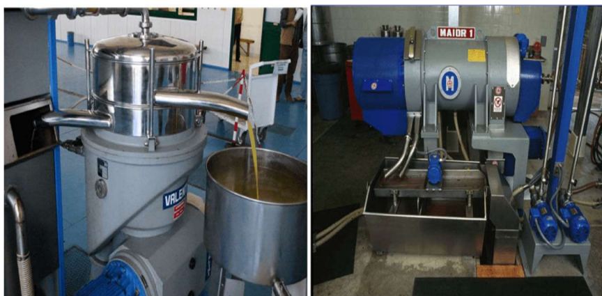
شکل 4- سانتریفیوژ افقی (سمت راست) و عمودی (سمت چپ) به منظور جداسازی روغن از خمیر و آب
