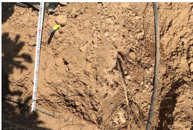
شکل ۶- عمق کارگذاری لوله آبدۀ قطره‌چکان‌دار در زیر سطح خاک و تجمع ریشه‌ها
