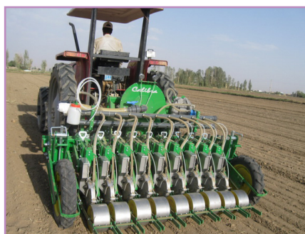
شکل ۹- دستگاه ریزکار پنوماتیک با قابلیت کشت بذور قدومه در مزرعه در سطح وسیع
