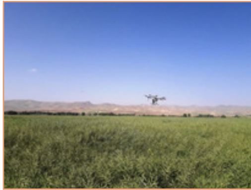
شکل ۱۹: سم پاشی مزرعه کلزا به وسیله پهپاد
