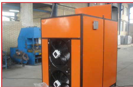
شکل ۴- انواع هیتر (بخاری گلخانه ای) با سیستم حرارت موضعی
