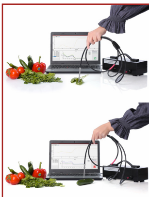
شکل ۱۴- سامانه غربالگری غیر مخرب سبزی‌ها از نظر انباشتِ نیترات.
