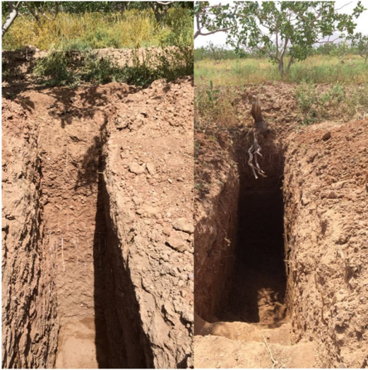
شکل ۱- پروفیل حفر شده جهت شناسایی خاک
