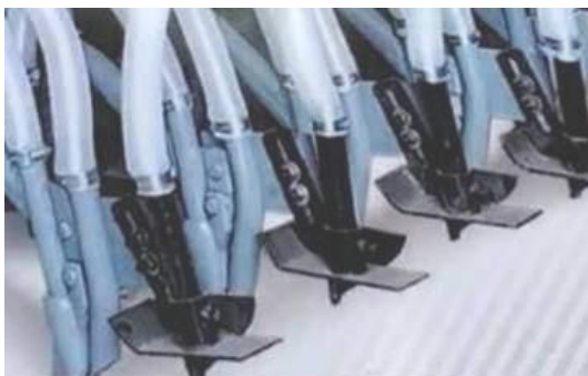
شکل ۱۹- نصب پاشنه یا اسکی تنظیم عمق جداگانه روی هر یک از واحدهای کارنده خطی کار برای جلوگیری از کاشت بذره‌های ریز در عمق بیش از حد
