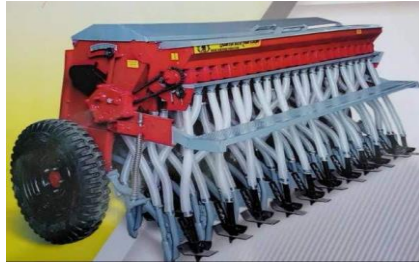
شکل ۲۰- خطی کار کودکار مجهز به مخزن جداگانه برای کود، بذرهای درشت و ریز و پاشنه یا اسکی تنظیم عمق بر روی هر واحد کارنده
