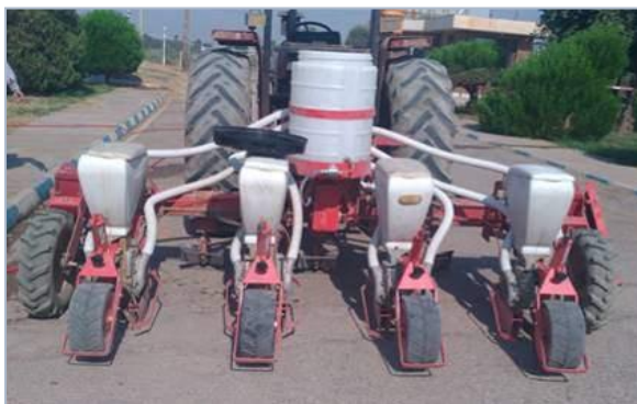
شکل ۱۷- ردیف‌کار دوقلو، برای کاشت به صورت دو ردیف روی هر پشته
