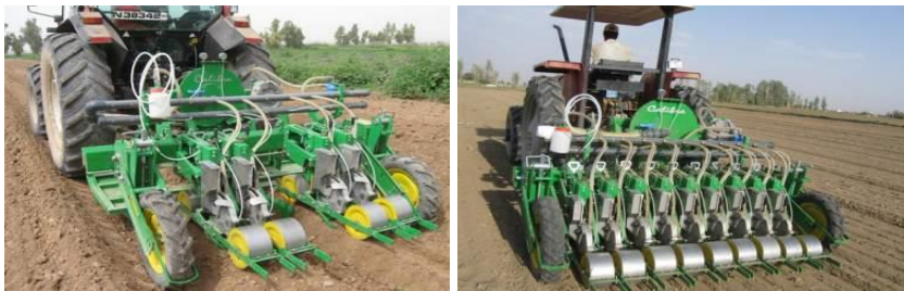
شکل ۱۶- ردیف‌کار پنوماتیک ریزدانه‌کار اسفوجیا، مدل CALIBRA (شرکت سبز دشت)
