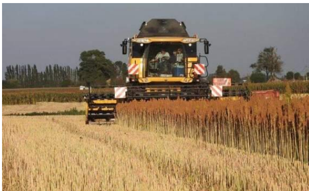
شکل ۳۵- برداشت مستقیم (یک مرحله‌ای) مزرعه کینوا با کمباین غلات
