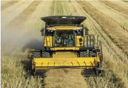
شکل ۳۳- برداشتن و خرمکوبی محصول نوار شده توسط کمباین مجهز به هد بلندکننده
