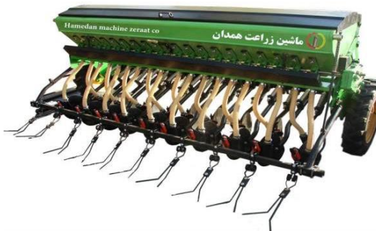
شکل ۲۱- خطی کار مجهز به شیار بازکن دیسکی برای کاشت بذر در زمین‌های سنگین رسی، کلوخه‌ای و حاوی بقایای گیاهی.
