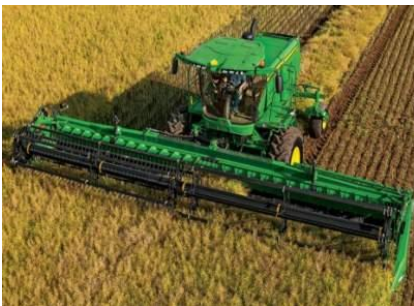
شکل ۳۱- بریدن و نوار کردن بوته‌های کینوا در مزرعه توسط ماشین درو-ردیف‌کن
