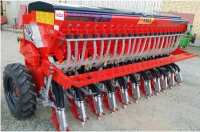
شکل ۲۰- خطی کار کودکار مجهز به مخزن جداگانه برای کود، بذرهای درشت و ریز و پاشنه یا اسکی تنظیم عمق بر روی هر واحد کارنده
