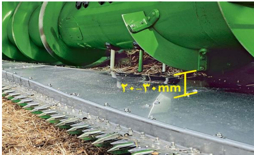
شکل ۳۹- فاصله هلیس (مارپیچ) تا کف سکوی برش کمباین
