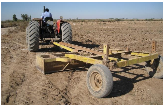
شکل ۱۱- هموارسازی نهایی سطح مزرعه با لولر
