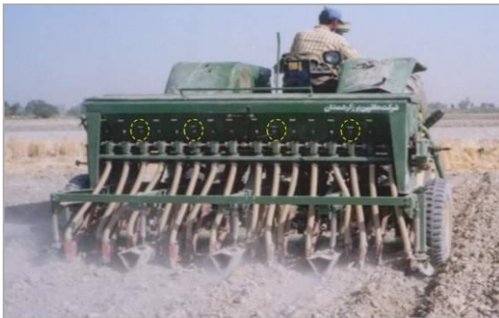
شکل ۲۲- بستن دريچه بذر واحدهای کارنده میانی خطی کار (با دایره خط چین زرد مشخص شده) برای کاشت کینوا به صورت دو خط روی پشته
