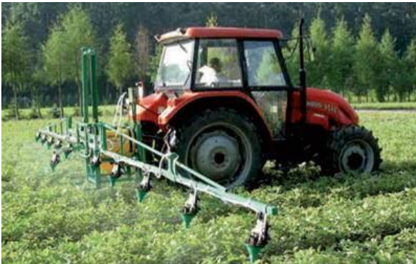
شکل ۲۵- کنترل آفات و بیماری‌ها با سمپاش بوم‌دار پشت تراکتوری مجهز به افشانک میکرونر
