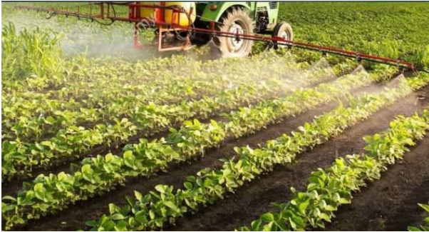
شکل ۲۴- کنترل آفات و بیماری‌ها با سمپاش بوم‌دار پشت تراکتوری مجهز به افشانک بادبزنی
