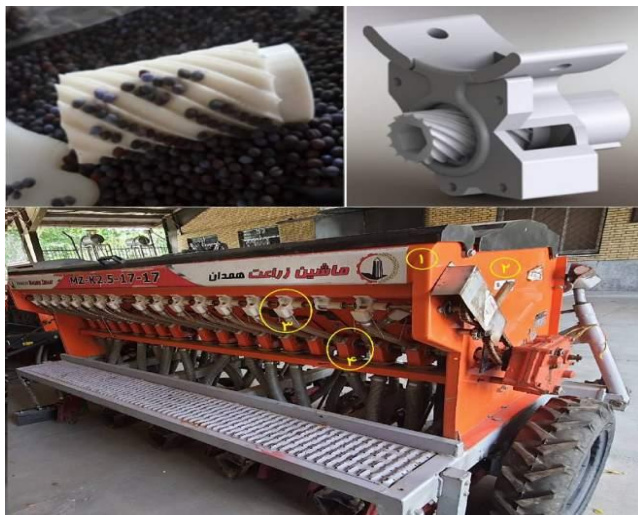
شکل ۱۸- خطی کار غلات با توانایی کاشت نسبتاً دقیق بذره‌های ریز، مانند کینوا، کلزا و شبدر (۱) مخزن بذره‌های ریز، (۲) مخزن‌های بزرگ بذر و کود، (۳) موزع استوانه‌ای با شیارهای مورب ویژه کاشت بذره‌های ریز و (۴) موزع استوانه‌ای مرسوم برای کاشت بذره‌های متوسط و بزرگ
