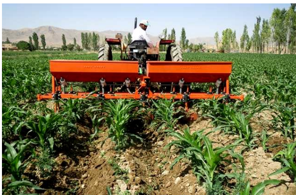
شکل ۳۰- کاربرد کولتیواتور بین ردیفی مجهز به کودکار با تراکتور چرخ باریک در مزرعه ذرت
