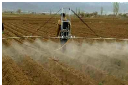
شکل ۲۶- کنترل علف‌های هرز، آفات و بیماری‌ها با سمپاش پستی لانس‌دار
