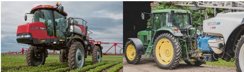
شکل ۲۳- تراکتور چرخ باریک برای عملیات داشت بین ردیف‌های کاشت
