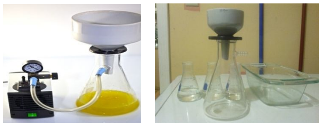
شکل 1-8- لوازم اندازه‌گیری وزن مخصوص ظاهری و حقیقی بستر کشت بدون خاک
