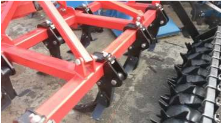
نمایی از شاسی دستگاه و موقعیت قرار گیری ساقه ها به روی شاسی
