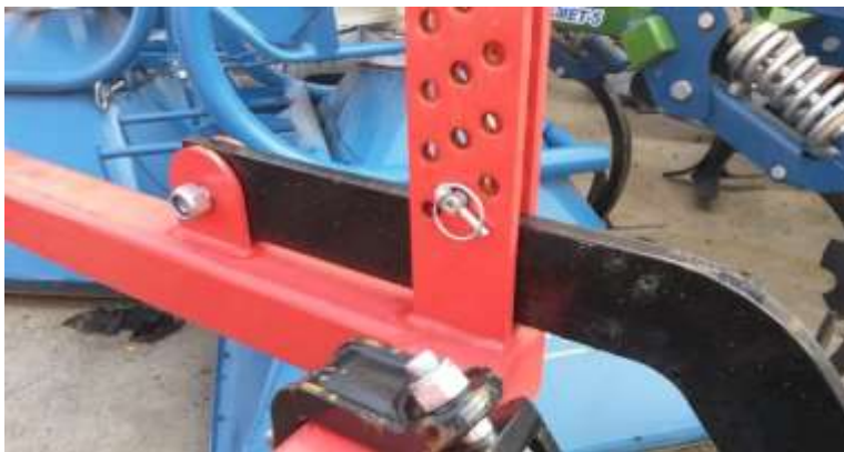
پین و خار استاندارد بکار گرفته شده جهت تنظیم دامنه حرکت غلتک دستگاه
