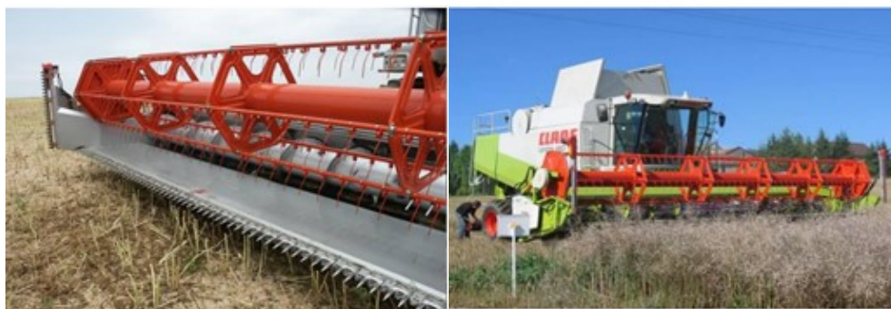
شکل ۱۵- استفاده از هد مخصوص کلزا با تیغه برش عمودی
