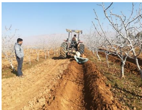
شکل ۵- استفاده از ماشین نه‌رکن برای ایجاد نهر در دو طرف ردیف درختان
