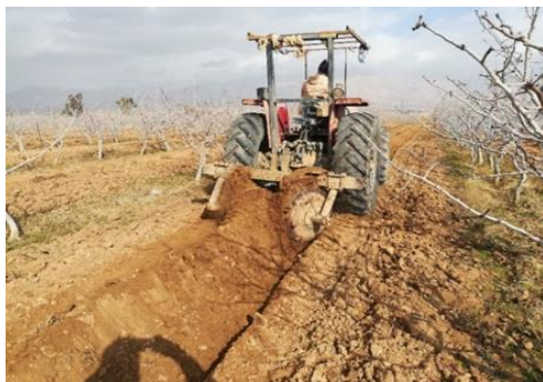
شکل ۳- استفاده از ماشین موزبند برای ایجاد مرز در وسط ردیف
