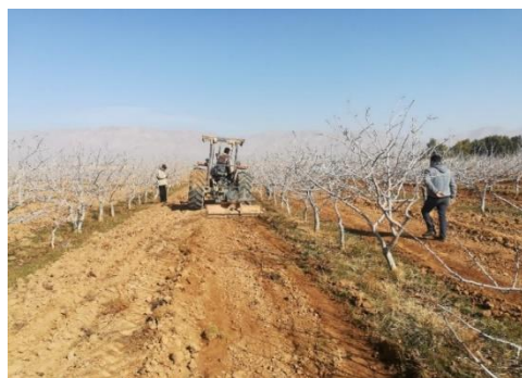
شکل ۴- استفاده از ماشین کدول برای ایجاد بستر سینه‌مرغی در دو طرف ردیف درختان
