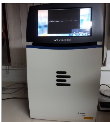
شکل 4- دستگاه ژل داک استفاده شده برای ثبت تصویر ژل تحت نور UV.
