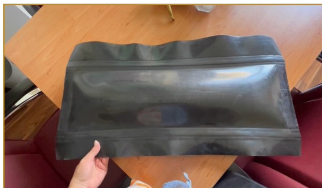
شکل ۷- نمونه‌ای از پوشش ژئوممبران شناور
