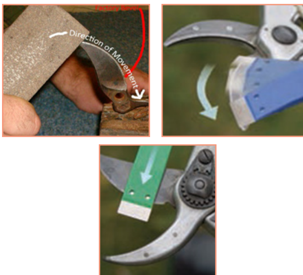
شکل ۳۳. تیز نمودن لبه درونی قیچی (عکس بالا) و تیز نمودن لبه بیرونی قیچی (عکس پایین)
