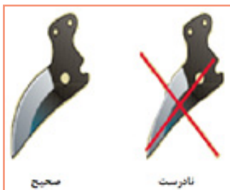
شکل ۳۲. هدف از تیز کردن حذف ناصافی‌ها و بازیابی زاویه مناسب است
