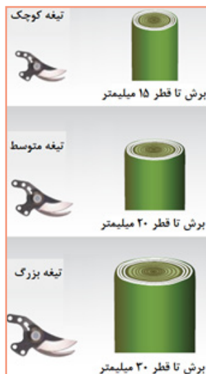
شکل ۲۰. ابعاد مختلف تیغه باتوجه به قطرهای مختلف برش
