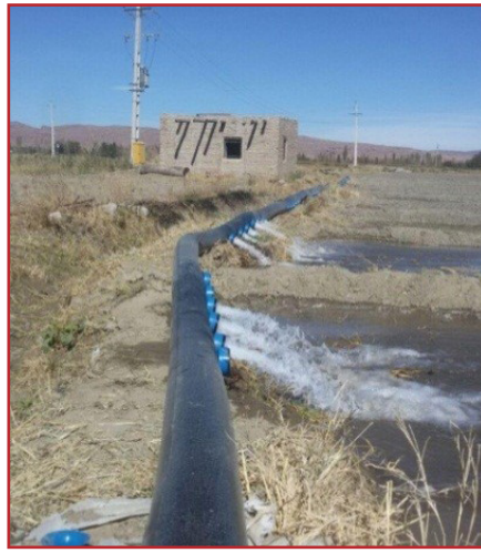
شکل ۱۷ - ورود آب از دریچه‌های آبگیر روی لی فلت به ابتدای نوار آبیاری
