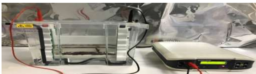
شکل ۷- الکتروتراپی ریزنمونه های ارقام زردآلو آلوده به ویروس به منظور حذف آلودگی ویروسی
