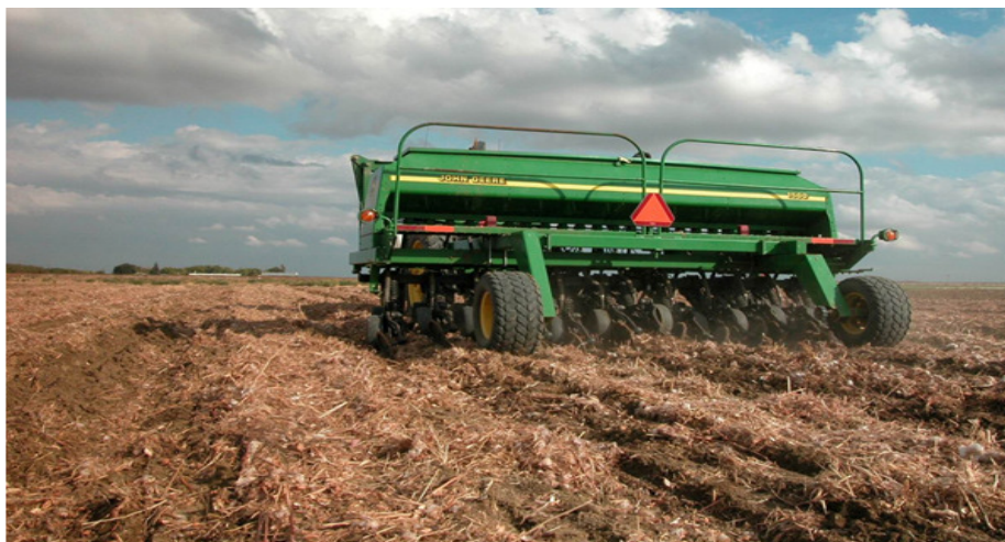
دستگاه گاوآهن مرکب با انجام چند عملیات زراعی بطور همزمان باعث کاهش مصرف سوخت میگردد
