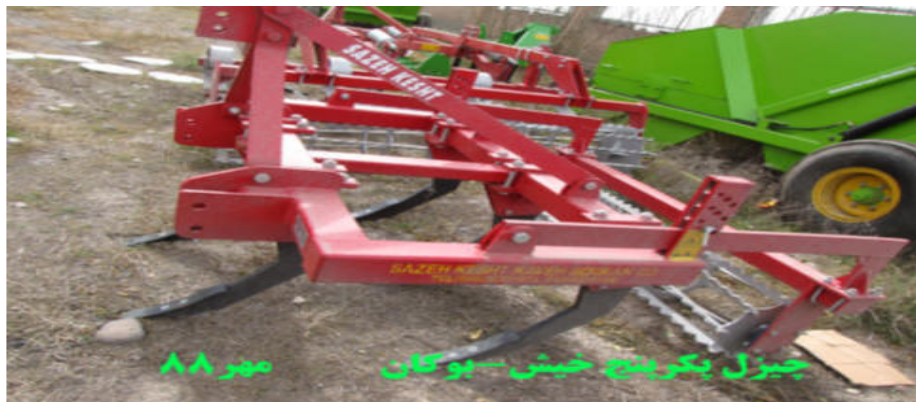
دستگاه چیزل پکر باعث حفظ رطوبت خاک در اراضی دیم و شخم عمیق در اراضی آبی میشود
