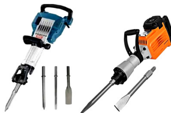
شکل ۶ - چکش برقی (راست) و چکش و قلم‌های بادی (چپ) قابل استفاده برای جداسازی پاجوش
