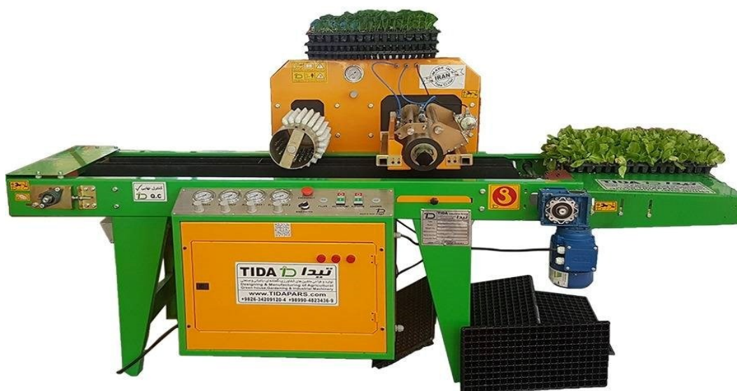
شکل ۲- دستگاه کاشت بذر پوشش‌دار
