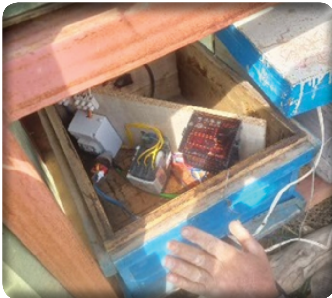
شکل ۶: سیستم هوشمند اتوماتیک کنترل دمای ساخته شده در مطالعه حاضر (Rahimi, 2024)
