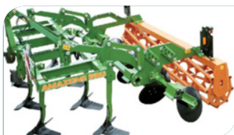
شکل ۴- خاک‌ورز مرکب با کلوخ خردکن دیسکی و غلتک قفسی شکل
