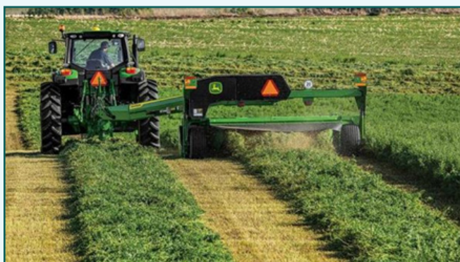
شکل ۵- عملکرد دروگر ساقه کوب
