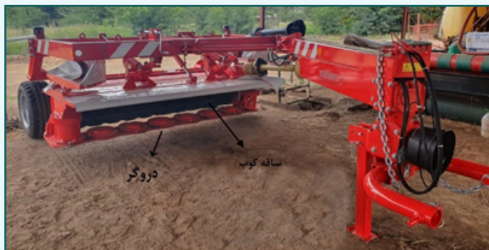
شکل ۳- دروگر ساقه کوب پشت تراکتوری
