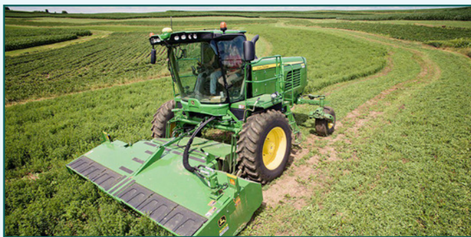
شکل ۷- سواتر مخصوص برداشت یونجه
