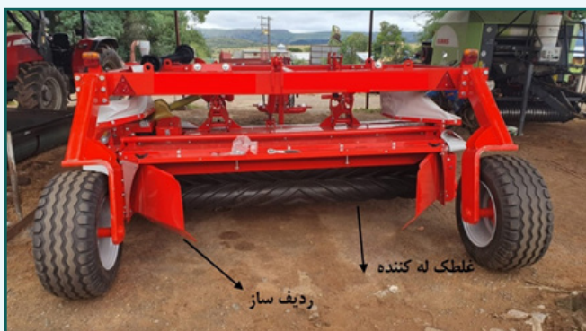
شکل ۴- اجزای ماشین دروگر ساقه کوب
