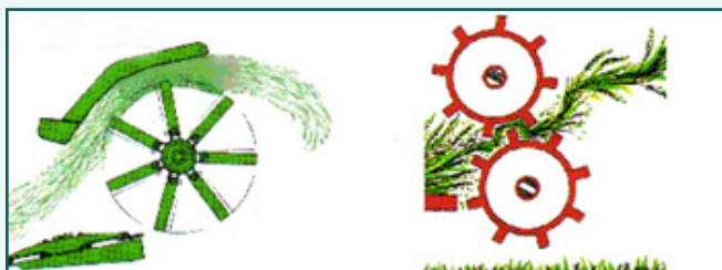
شکل ۶- غلتک‌های چین دهنده (سمت راست) و له کننده علوفه (سمت چپ)
