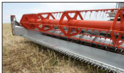
شکل ۱- هد مخصوص برداشت کلزا مجهز به تیغه برش عمودی
