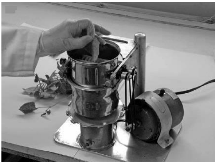
شکل ۳- دستگاه برس‌زن برای زدودن کنه‌ها (برگرفته از Hoy, 2011)
