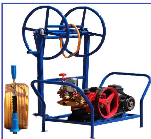
شکل ۱۷۰- شیلنگ جمع‌کن روی سمپاش زنبه‌ای (اینترنت)
