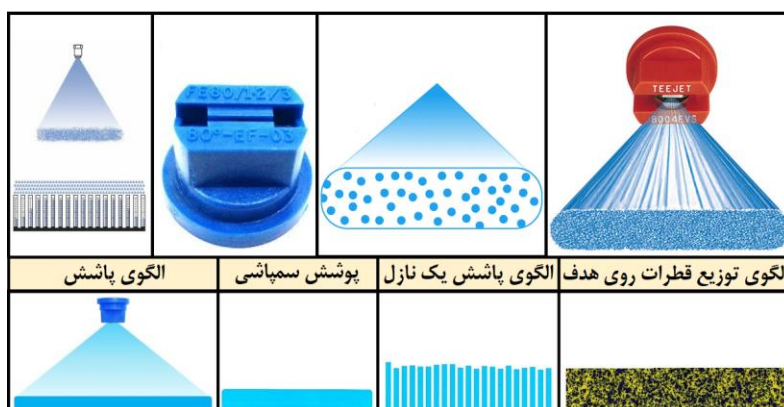
شکل ۳۹- نازل بادبزنی مسطح یکنواخت (اینترنت)
