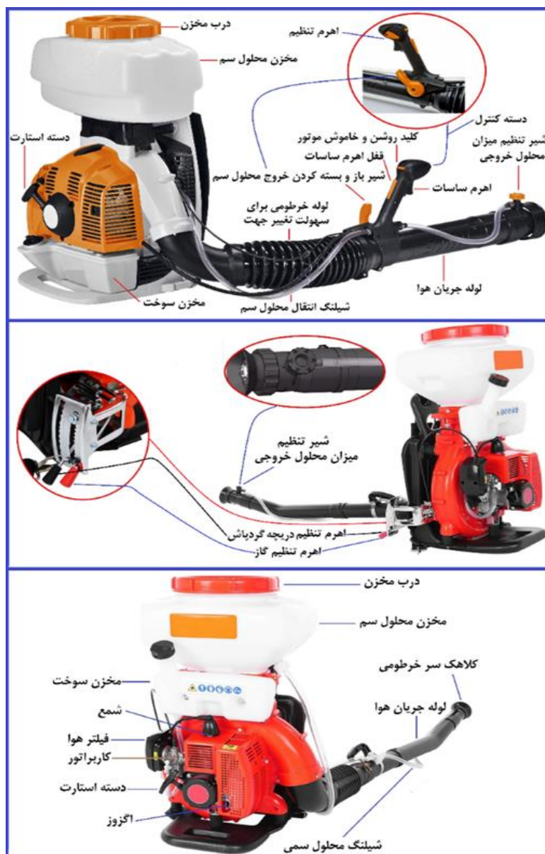
شکل ۱۲۴- اجزای سمپاش پشتی موتوری اتومایزر (اینترنت)
