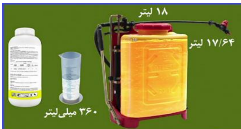
شکل ۲۴۹ - مقدار آب و سم مورد نیاز برای یک مخزن ۱۸ لیتری (اینترنت)
