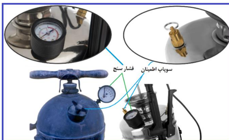
شکل ۵۸- فشار سنج و سوپاپ اطمینان (اینترنت)
