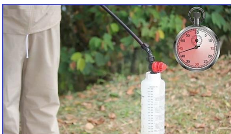
شکل ۲۲۰ - پاشش آب به مدت یک دقیقه (اینترنت)
