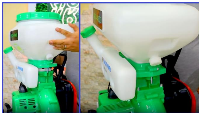
شکل ۱۴۴- بستن مخزن روی بدنه موتور (اینترنت)
