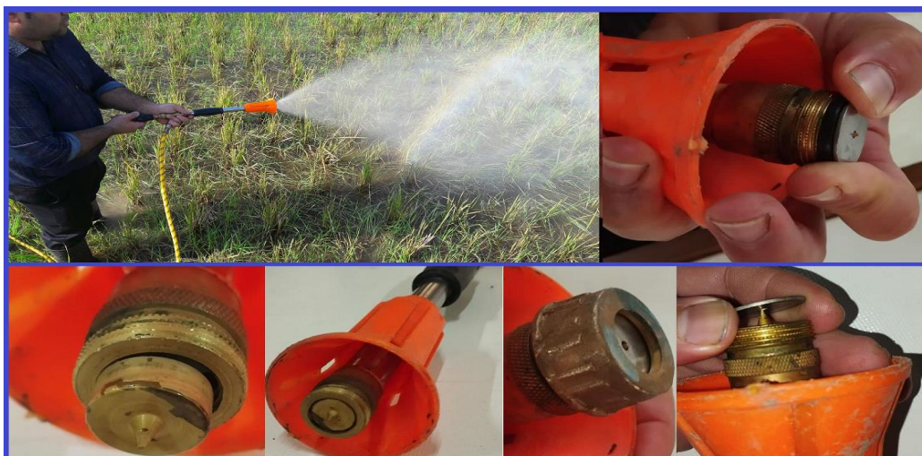
شکل ۲۷۴- حرکت پخش‌کن به سمت جلو با چرخاندن دسته لانس موافق عقربه‌های ساعت (اصلی)
