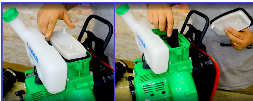
شکل ۱۴۱- درپوش محلول‌پاشی (سمت چپ) و دریچه خروجی کود شیمیایی، سموم گرانولی و گوگرد (سمت راست) (اینترنت)
