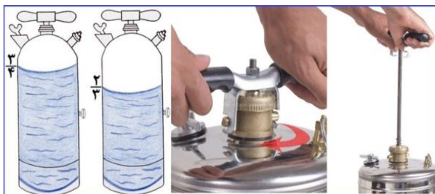
شکل ۶۲- ریختن محلول سمی، باز کردن درب مخزن و تلمبه‌زنی (اینترنت)
