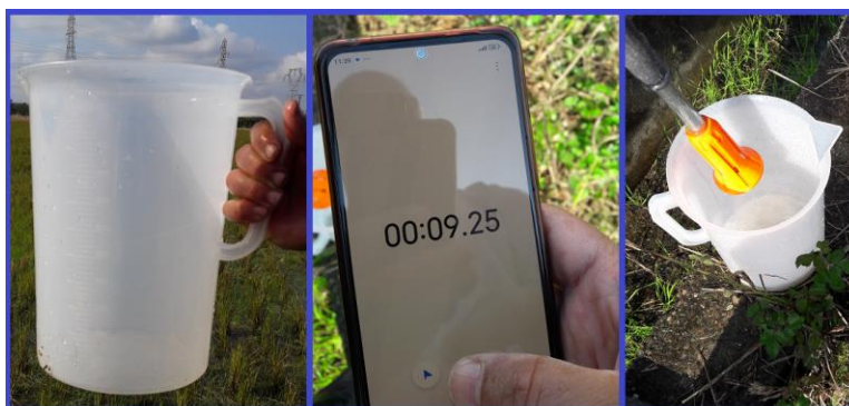
شکل ۲۷۶- اندازه‌گیری دبی نازل لانس (اصلی)
