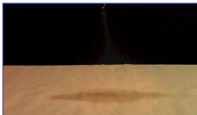
شکل ۹۴- پاشش در لبه‌ها ناقص و در وسط کامل (اینترنت)
