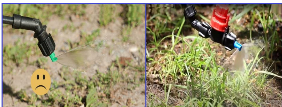
شکل ۸۴- سمپاشی صحیح با نازل شره‌ای (شکل سمت راست پاشش به سمت پایین)، سمپاشی غیر صحیح با نازل شره‌ای (شکل سمت چپ پاشش به سمت جلو) (اینترنت)
