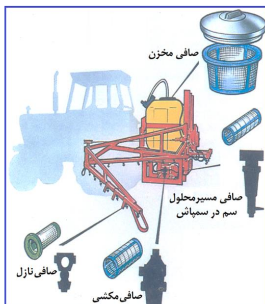
شکل ۲۰۳- محل‌های قرارگیری صافی روی سمپاش (اینترنت)
