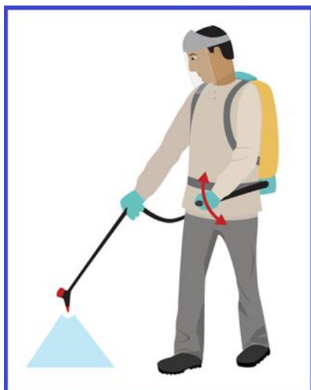
شکل ۲۰۸- تلمبه زدن ثابت (اینترنت)
