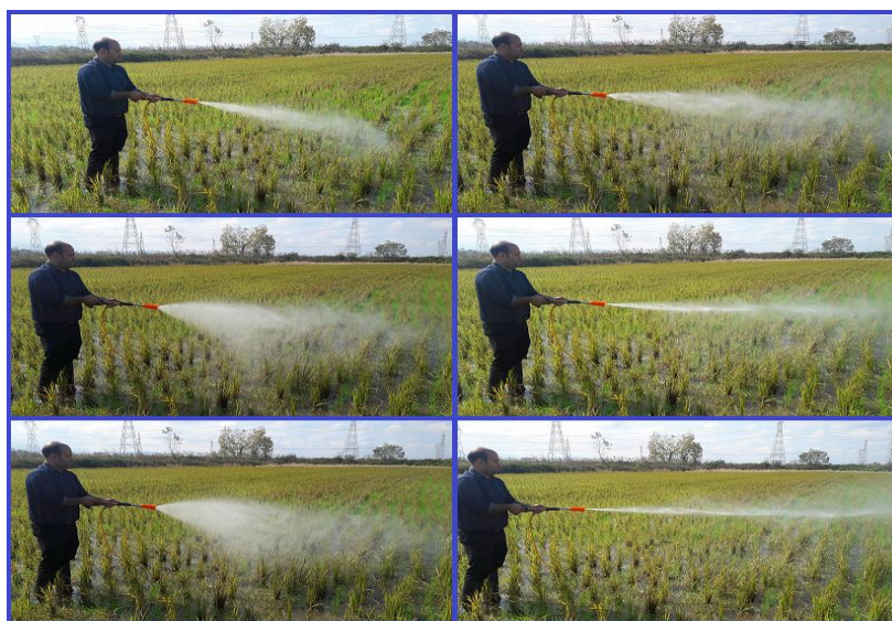
شکل ۱۶۳- تغییرات پاشش با تغییر فاصله‌ی پخش‌کن ماریچی نسبت به پولک (اصلی)
