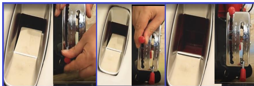
شکل ۱۴۹- تنظیم اندازه باز بودن دریچه با تغییر موقعیت اهرم (اینترنت)
