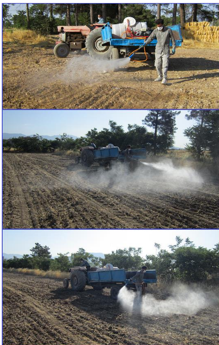
شکل ۲۱- پاشش غیریکنواخت در پاشش به‌صورت چپ و راست با سمپاش زنبه‌ای (اصلی)
