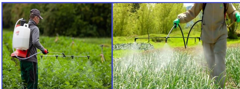
شکل ۸۷- کاربرد سمپاش پستی کتابی با بوم و نازل بادبزنی (شکل سمت راست با ۳ نازل و شکل سمت چپ با ۴ نازل) (اینترنت)
