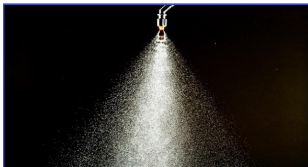
شکل ۸۶- الگوی قطره‌های محلول آفت کش خروجی از نازل بادبزنی یکنواخت (اینترنت)
