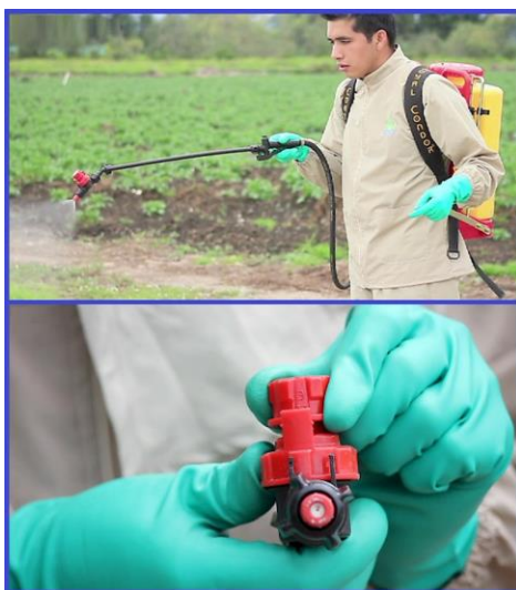
شکل ۲۱۲- تنظیم‌کننده فشار در ۳ بار (اینترنت)
