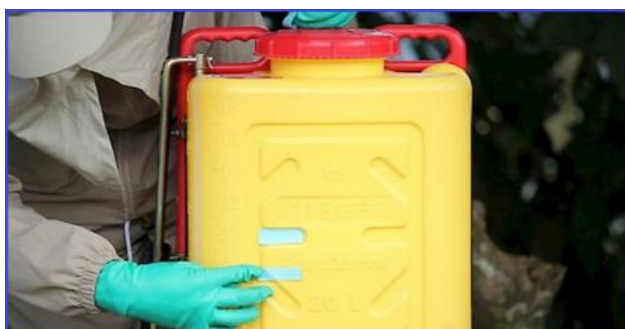
شکل ۲۳۷ - علامت زدن سطح جدید آب روی مخزن (اینترنت)
