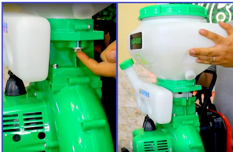
شکل ۱۳۹- جدا نمودن مخزن از روی بدنه موتور (اینترنت)
