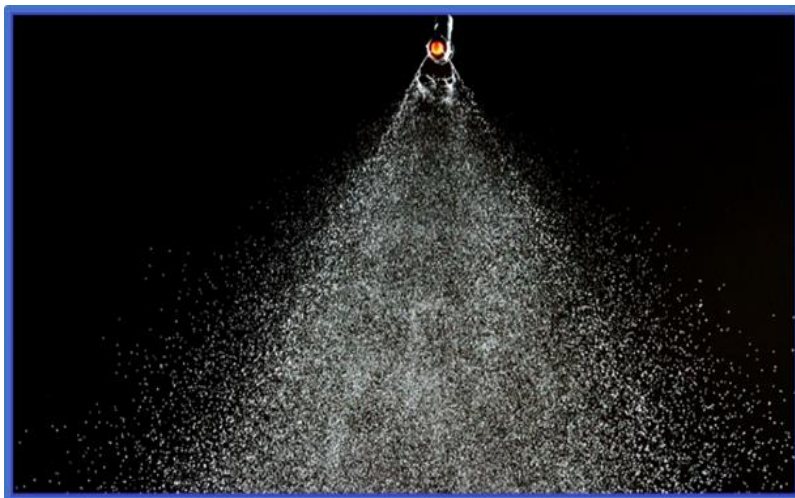
شکل ۸۱- الگوی پاشش قطره‌های محلول سم از نازل شره‌ای (اینترنت)
