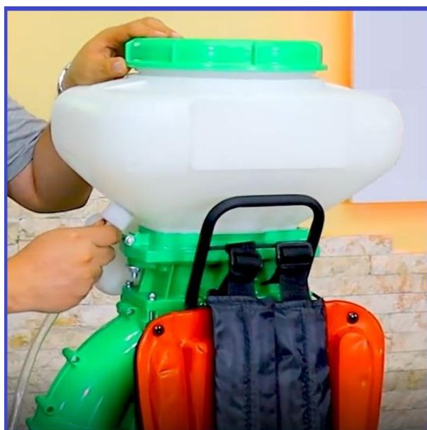
شکل ۱۳۶- جدا نمودن شیلنگ انتقال محلول از خروجی مخزن (اینترنت)
