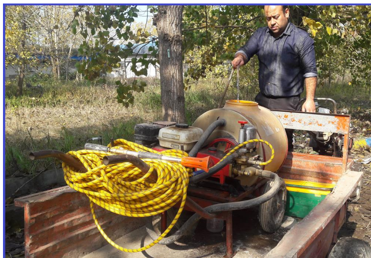
شکل ۲۶۸- ریختن آب داخل مخزن از طریق صافی مخزن (اصلی)
