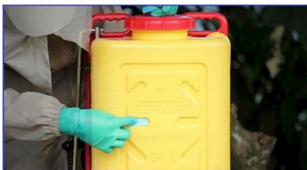
شکل ۲۳۵ - علامت زدن سطح آب روی مخزن (اینترنت)
