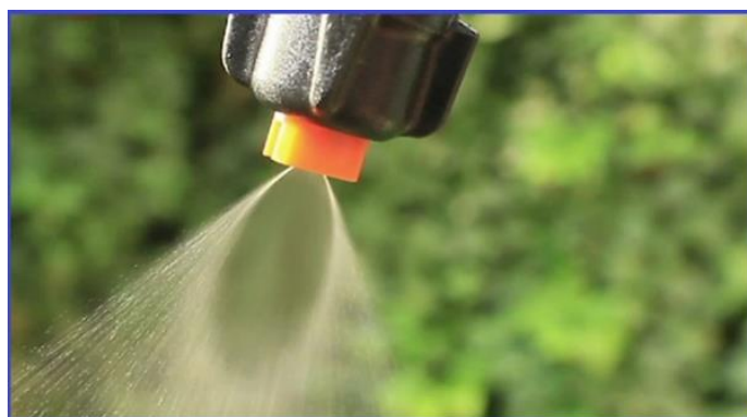
شکل ۹۳- پاشش مثلثی نازل‌های بادبزی مسطح استاندارد (اینترنت)
