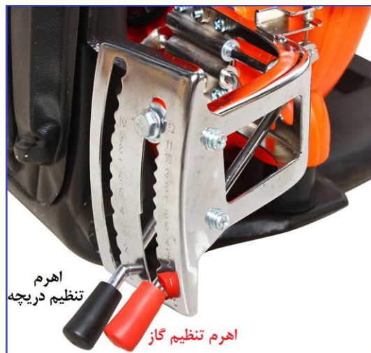
شکل ۱۴۸- اهرم‌های تنظیم گاز و دریچه (اینترنت)
