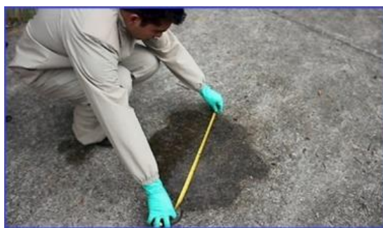
شکل ۲۲۶ - اندازه‌گیری پهنای پاشش (اینترنت)
