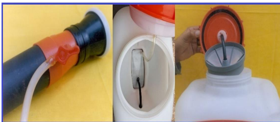
شکل ۱۲۶- از راست به چپ: درب مخزن - حوضچه ته مخزن - شیر اصلی قطع‌کن
