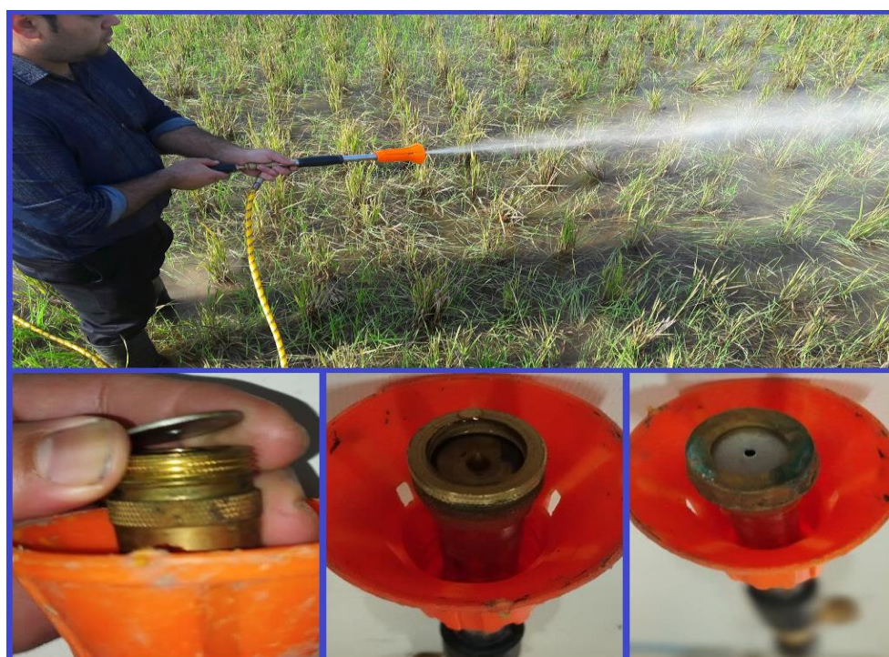
شکل ۲۷۵- حرکت پخش‌کن به سمت عقب با چرخاندن دسته لانس مخالف عقربه‌های ساعت (اصلی)
