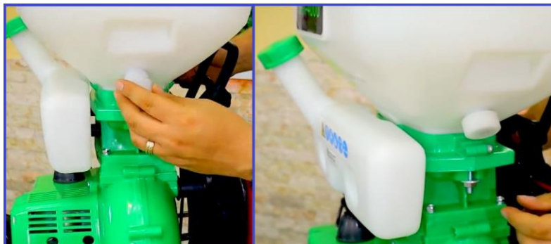
شکل ۱۳۸- بستن درپوش روی خروجی محلول از مخزن (اینترنت)
