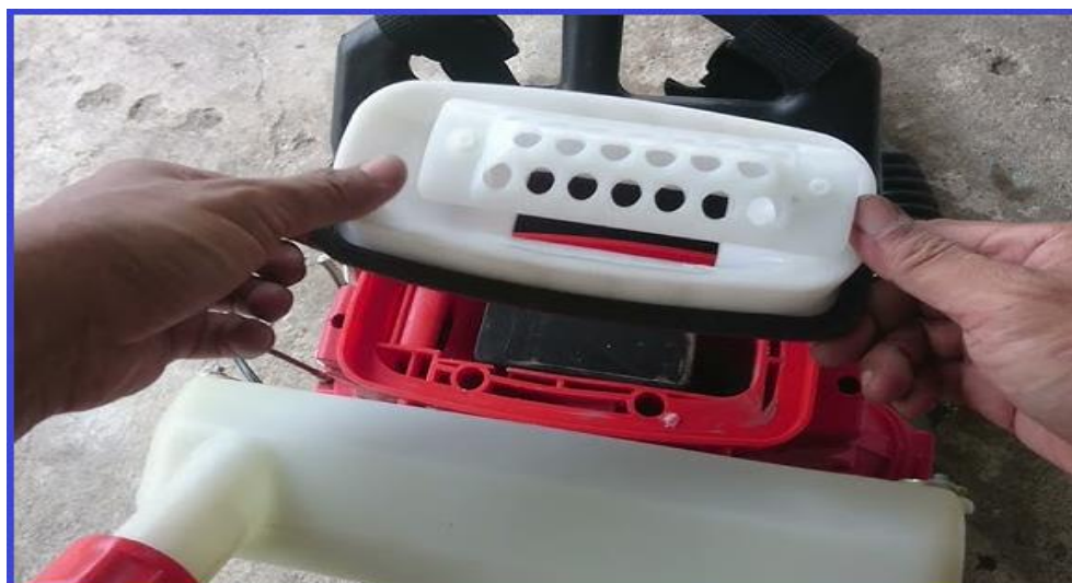
شکل ۱۴۲- درپوش مخصوص برای پاشش کودهای شیمیایی، سموم گرانولی و گوگرد (اینترنت)
