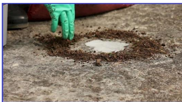
شکل ۲۶۲- استفاده از خاک اره و ماسه برای جذب محلول ریخته شده (اینترنت)
