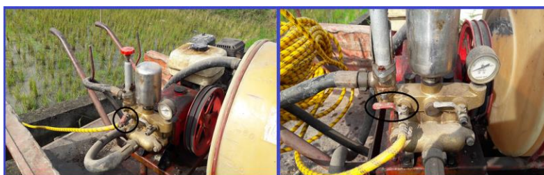
شکل ۲۷۰- باز کردن شیر خروجی پمپ (اصلی)
