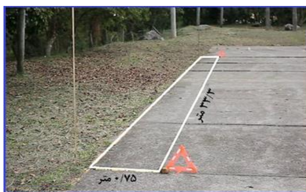
شکل ۲۳۹- محاسبه مقدار محلول جهت پاشش در ۲۵ مترمربع (اینترنت)
