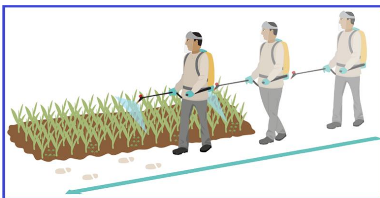
شکل ۲۲۱ - ثابت نگهداشتن ارتفاع پاشش (از نازل تا هدف) (اینترنت)
