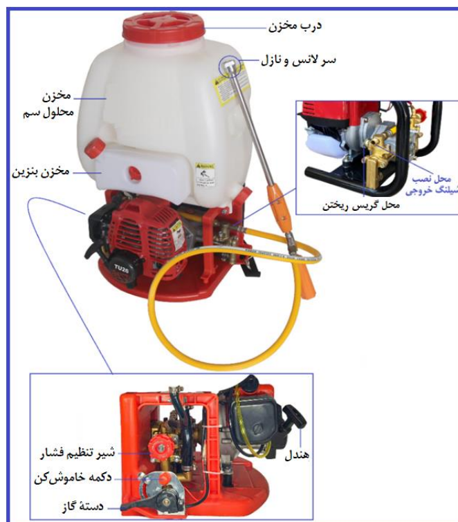
شکل ۱۰۴- اجزای سمپاش پشتی موتوری لانس‌دار (اینترنت)
