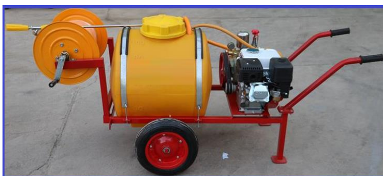
شکل ۱۵۲- شیلنگ جمع‌کن روی سمپاش فرغونی (اینترنت)
