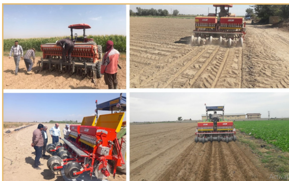
شکل ۶- تصاویری از کاشت کلزا با استفاده از کارنده‌های بذرکار کودکار غلظتی گندم‌کار پارس (سمت راست و سمت چپ پایین) و بذرکار برزگر همدان (سمت چپ بالا) در شهرستان نظرآباد
