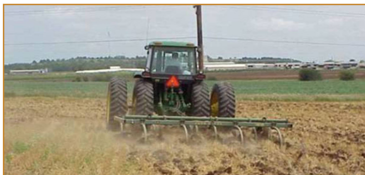
شکل ۸- گاوا آهن پنجه‌غازی مناسب برای خاک‌ورزی پوششی
