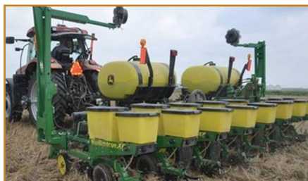
شکل ۱۱- بی خاک‌ورزی. این دستگاه بدون برهم زدن خاک، در بقایای غلات کشت می‌کند.
