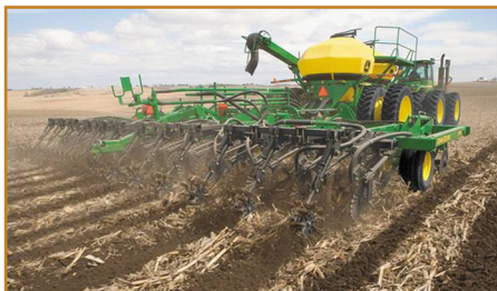
شکل ۱۵- دستگاه خاک‌ورز مرکب یا کمبینات
