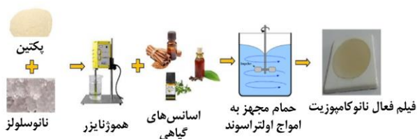
شکل ۱۹- مراحل کلی ساخت فیلم فعال نانوکامپوزیت بر پایه اولتراسوند
