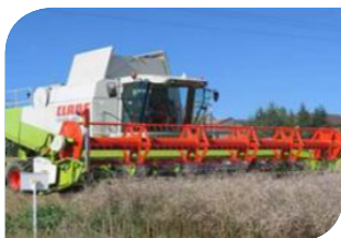
شکل ۲۲- استفاده از هد مخصوص کلزا با تیغه برش عمودی
