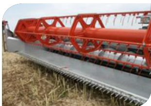
شکل ۲۲- استفاده از هد مخصوص کلزا با تیغه برش عمودی
