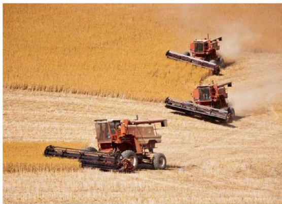
شکل ۷- برداشت غوزه (دانه) گلرنگ توسط کمباین غلات
