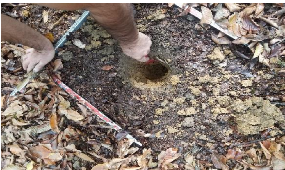
شکل ۴) نمونه‌برداری خاک معدنی زیر لایه لاشبرگی در جنگل خیرودکنار
