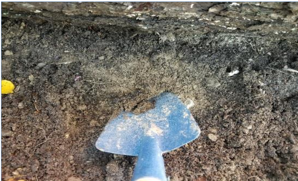
شکل ۳) نمونه‌برداری خاک معدنی زیر خشک‌دار افتاده در جنگل خیرود
