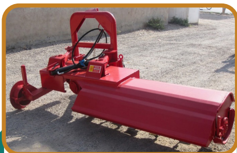
شکل ۲- رتیواتور کشویی ساخت شرکت داخلی مخصوص خاک‌ورزی زیر سایه‌انداز درختان
