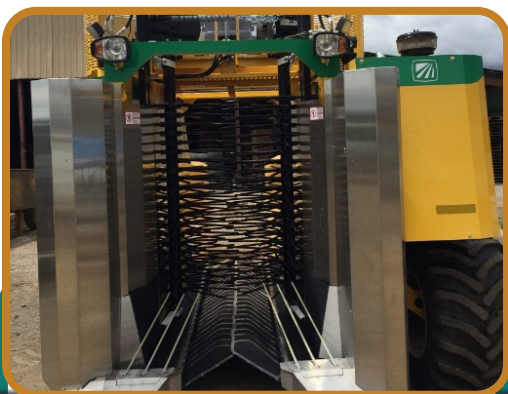
شکل ۸۰- شیکر ضربه زن برداشت مرکبات
