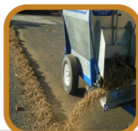
شکل ۵۸- ماشین پخش مالچ و کود گیاهی و دامی در باغات
