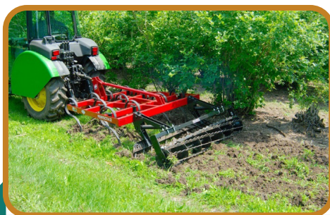
شکل ۸- خاک‌ورز مرکب، مناسب برای شخم در باغات
