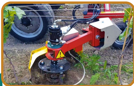
شکل ۵- رتیواتور سنسوردار مخصوص خاک‌ورزی در باغات مختلف، از جمله باغات مرکبات، ساخت شرکت داخلیر
