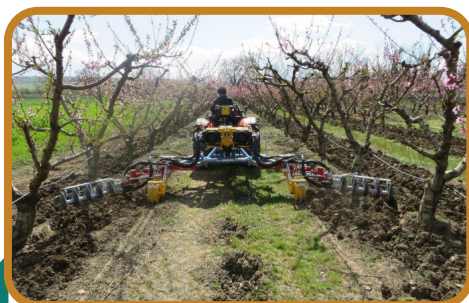
شکل ۱۱- دیسک مناسب برای خاک‌ورزی باغات (دو ردیف درخت) در باغات
