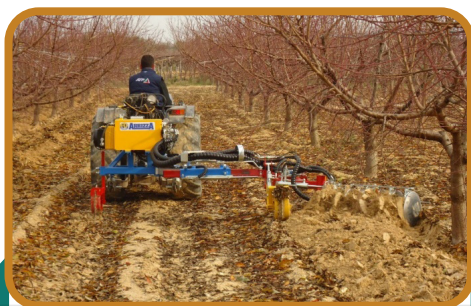
شکل ۱۰- دیسک افست مناسب برای خاک‌ورزی باغات
