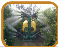
شکل ۴۷- سم‌پاش باغی مناسب برای سم‌پاشی مرکبات
