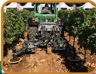
شکل ۷- خاک‌ورز سیکلوتیر دوطرفه برای خاک‌ورزی زیر سایه‌انداز درخت
