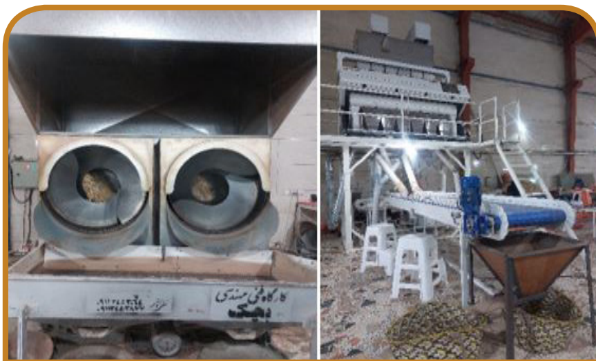
شکل ۱۱- راست) دستگاه لیزری برای جدا کردن بادام زمینی با کیفیت‌های مختلف، چپ) کوره پخت بادام
