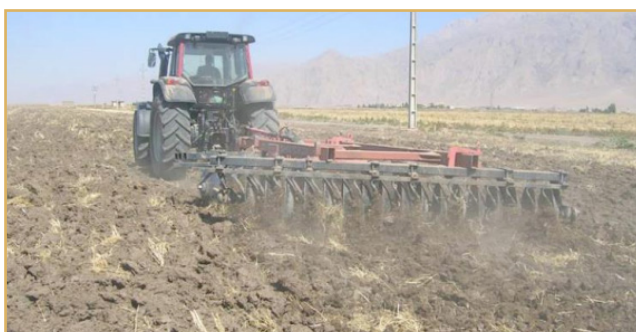
عکس شماره ۵: عملیات دیسک (برای خُرد کردن کلوخه‌ها و آماده‌سازی بستر کاشت کلزا)
