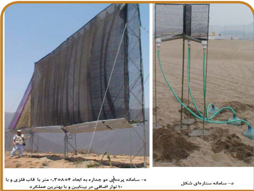
شکل ۱۳- ساخت اشکال دیگری از سامانه‌های جمع کننده مه
