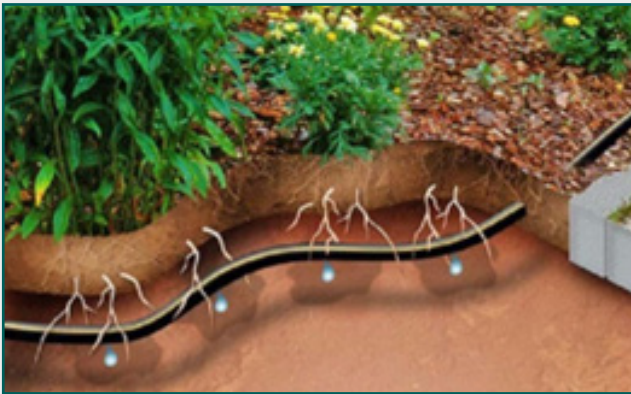
شکل ۴. انسداد نازل قطره‌چکان‌ها بر اثر نفوذ ریشه
