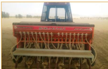
شکل ۶- کاشت با دستگاه خطی کار همدانی
