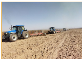
شکل ۳- عملیات شخم با گاواهن برگردان‌دار دو طرفه
