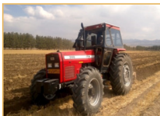
شکل ۲- عملیات شخم با گاواهن برگردان‌دار یک‌طرفه
