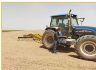
شکل ۵- تسطیح مزرعه با لولر
