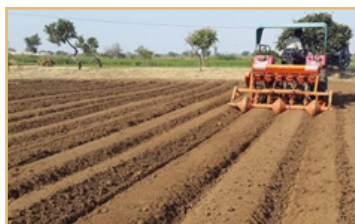
شکل ۳- دستگاه کاشت روی پشته‌های بلند و عریض
